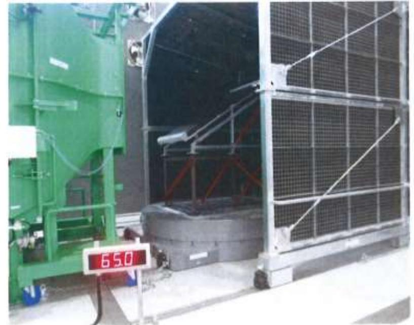
写真3 試験実施状況(突風試験 最大風速：65m/s 到達時)
