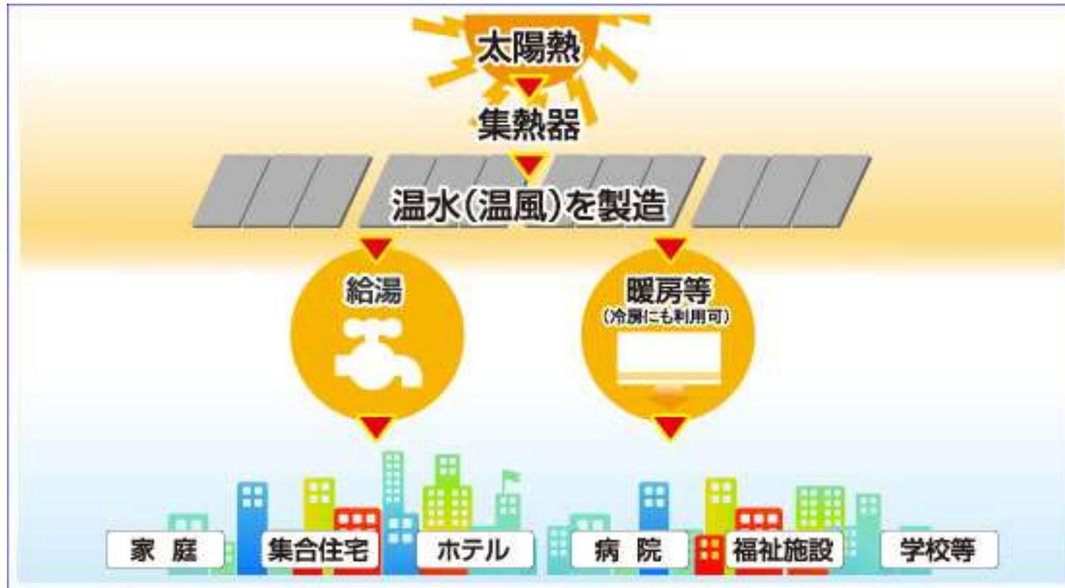
太陽熱利用システムは「再生可能エネルギー」のひとつであり、太陽の熱を使って温水を作り、給湯や冷暖房に利用するシステムです。
